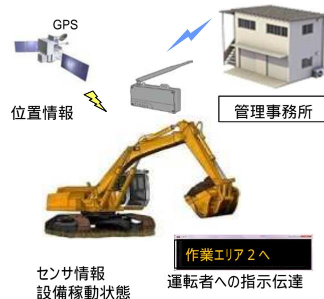
重機に搭載したGPSの位置情報やセンサ情報を、管理事務所からデータ収集して管理すると同時に重機の操縦者に対する作業指示の伝達も可能となります。
