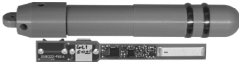
図1 腔内センサーの本体（直径20mm、長さ160mm）と無線端末。
