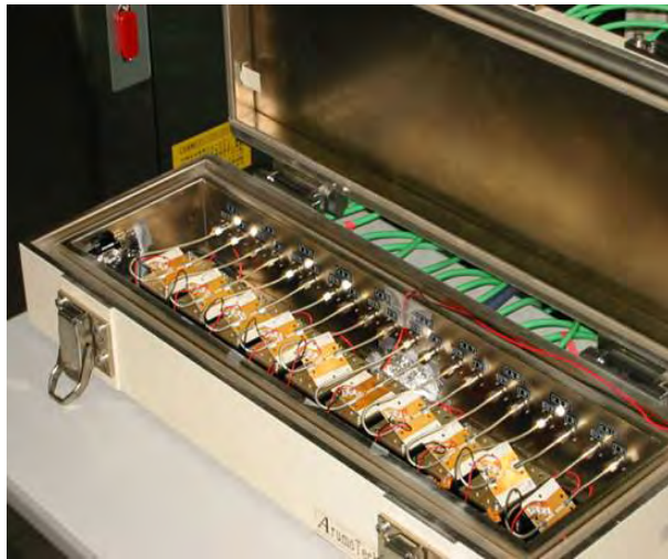
図 41 高周波信頼性評価装置 (左:シールドボックス内、右:評価中の RF スイッチ)
