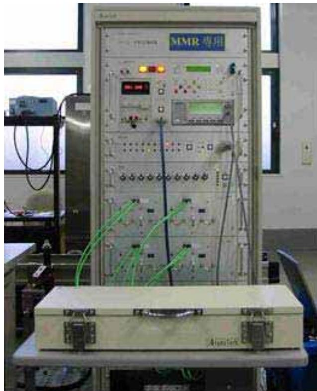
図 40 高周波信頼性評価装置 全景
