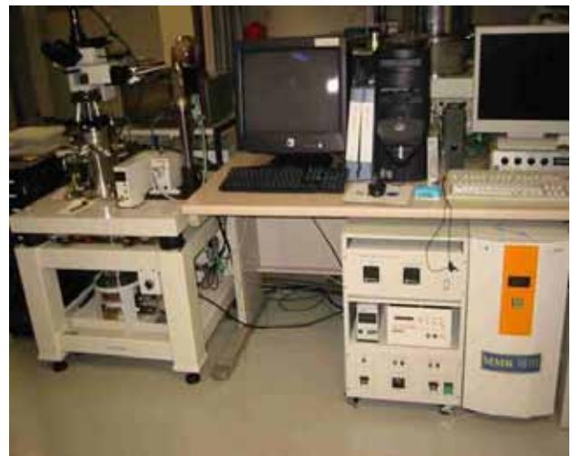
図30-2 走査型プローブ顕微鏡システム
