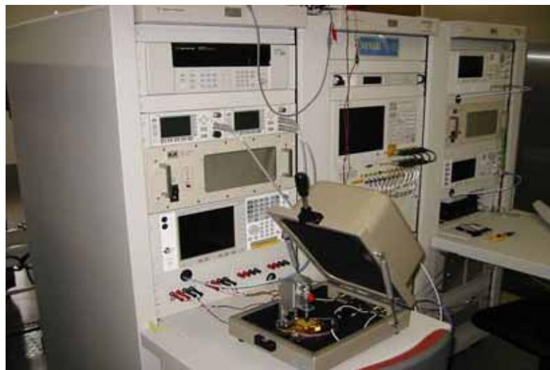
図 46 RF スイッチテストシステム
