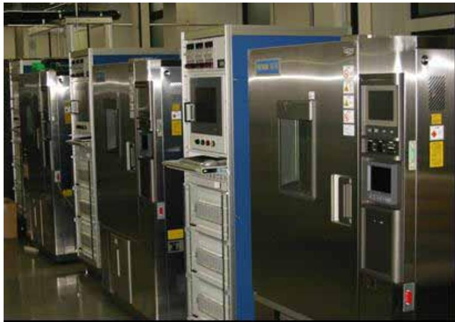
図29 超長期接点寿命評価装置(E-life Tester)
