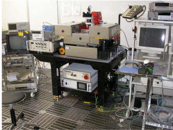
図②-14 測定系の写真 (プローバは 8 インチオートプローバー Süss Microtec PA200)
