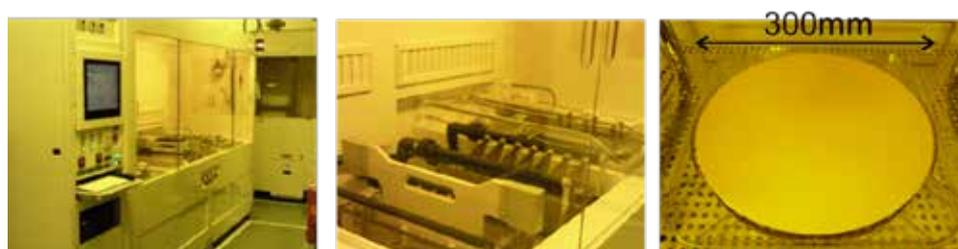
図 - (5)-5-2-2.2 300mm ウェハ対応 Cu めっき装置
