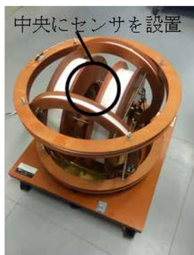
図 - (1)-2-3.1 磁気検出性能評価用ヘルムホルツコイル
