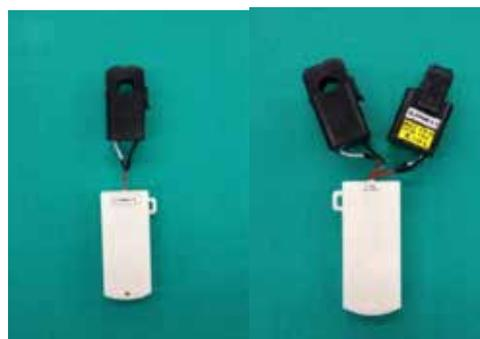
図 -(4)-4-2-2.1a 30A (シングル、マルチ) 図 -(4)-4-2-2.1b 60A (シングル、マルチ)
