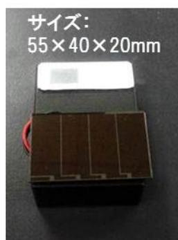
図 -(1)-3-1.1 1次試作センサ端末
