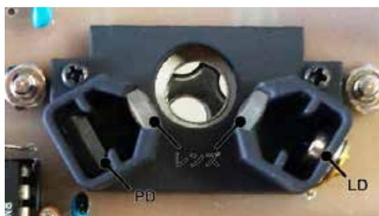
図 -(2)-3-1.3 試作した塵埃検出部
