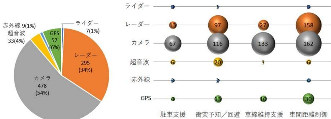
図 3-④-(2)-(3)-4. 日本出願の運転支援システムに用いられる認識センシング技術
