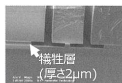
SOIウエハの酸化膜層を犠牲層として利用した加工例 (キャノンマーケティングジャパン(株)殿ご提供)
