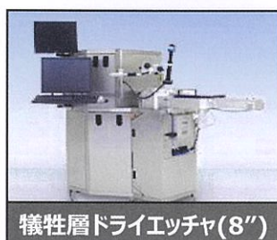
SOIウエハを用いた センサ可動構造体のリリース
