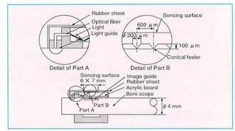
図2 本触覚センサの構造
