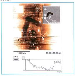
図3 AFMによる加工痕と断面プロファイル
