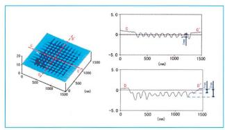
図3c-Bnチップによる格子溝の加工例
