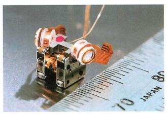
図 2 走行用マイクロ単体マシン (住友電気工業(株)、松下技研(株)と共同で開発)
