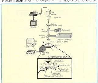
図2 光放射圧マイクロ加工の実験装置
