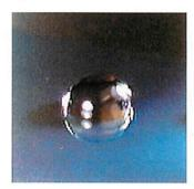
図3. 製作したテフロン系膜上での水の接触角
