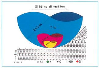
図1AFMによるマイカの加工モデル
