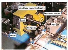
図2 加工装置の外観写真
