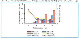
図3 表面粗さと研磨量の時間的変化 [回転数の影響]
