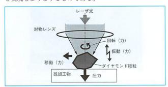
図1 光放射圧マイクロ加工の考え方
