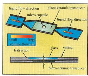
図2 バルブレスポンプ概略図
