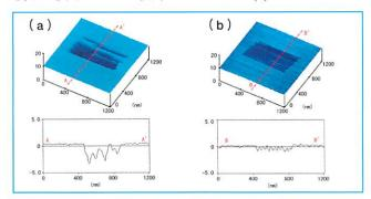
図 2 ラインアンドスケールの加工結果 (a) S i チップによる加工例 (b) c-BNチップによる加工例
