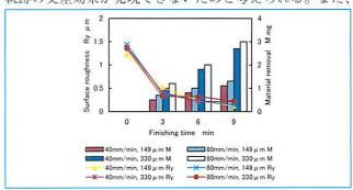
図4 表面粗さと研磨量の時間的変化 〔鉄粉径と送り速度の影響〕
