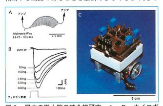
図 2 昆虫の微小脳の統合的研究。A、B カイコガ の触角の先端と基部の間で生じる匂い(フェロ モン)に対する濃度依存的な電位応答。C 触 角(矢印)を匂いセンサとした小型移動ロボット。
