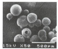
図1 マイクロカプセルの電子顕微鏡写真
