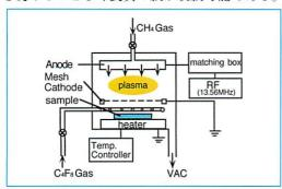
図1. プラズマ重合装置の構造
