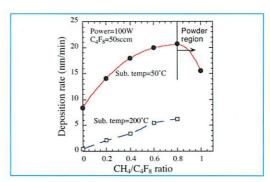
図2. テフロン系膜の堆積速度とCH<sub>4</sub>/C<sub>4</sub>F<sub>8</sub>比と 基板温度の関係
