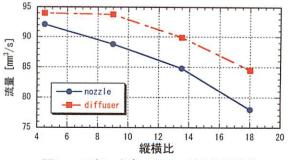
図3 ノズル/ディフューザの流量特性
