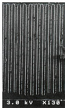
図2 貫通孔の断面SEM写真
