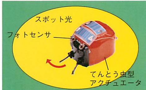
図2. てんとう虫型アクチュエータの動作図
