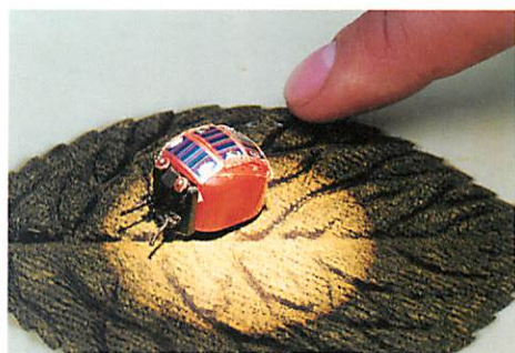
図2・昆虫型アクチュエータへの光エネルギー供給
