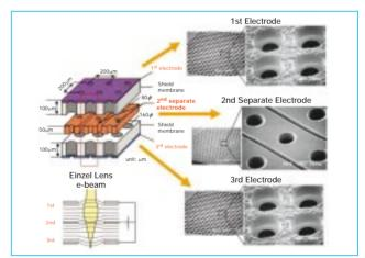
Fig. 2 Einzel lens array
