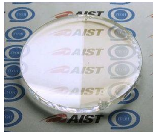
ナノ表面構造による反射防止機能(右半分)
