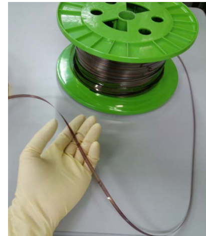
巻き取った成膜済基材 (PET, 幅5mm)
