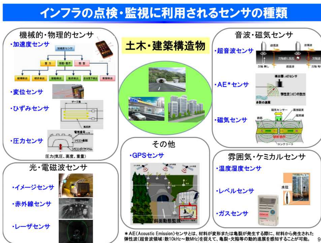
図表 2.14 社会インフラの点検・監視に利用されるセンサの種類
