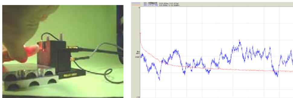
図 23 指先組織血流、駆決時の散乱信号による時間軸データとパワースペクトラム
