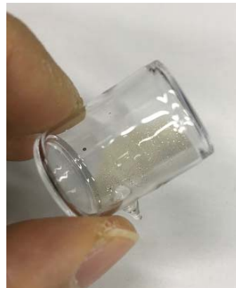
パイレックスガラス製のガスセルに封入されたセシウム原子
