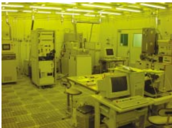
図1 利用している70m 2 、クラス1000のクリーンルーム
