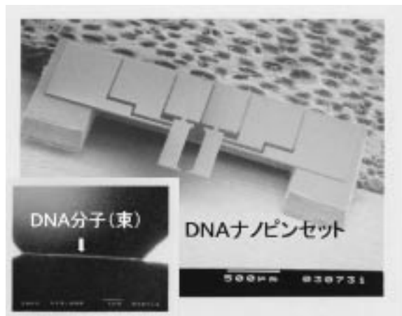
図2 DNAナノピンセットと溶液中から分取したDNA分子(-DNA)のSEM写真
