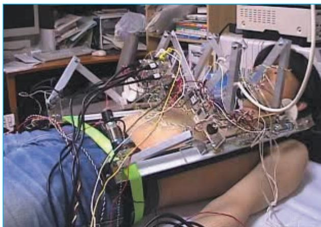
図2 臓器の観察と超音波の照射をするための体表上乗せ式超音波探触子制御ロボット
