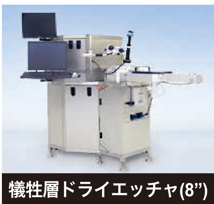
SOIウエハを用いた センサ可動構造体のリリース
